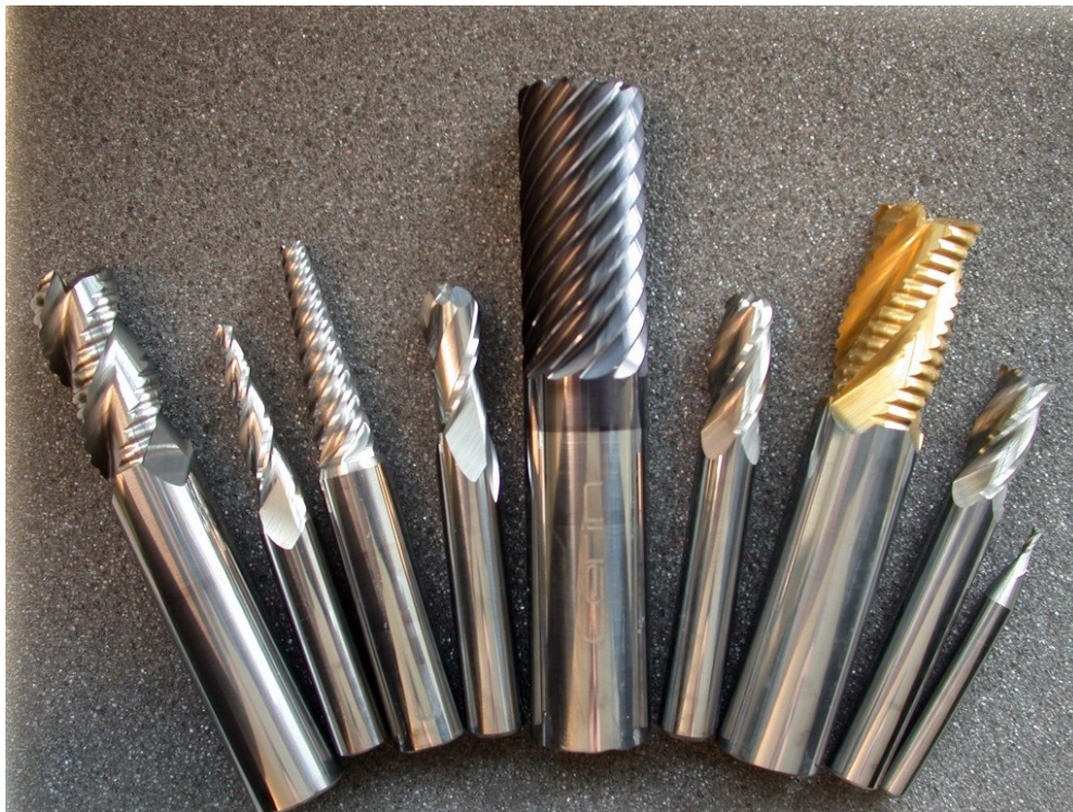
Figura N°1 – Insieme di frese cilindrico frontali in metallo duro (cortesia CERIN)
